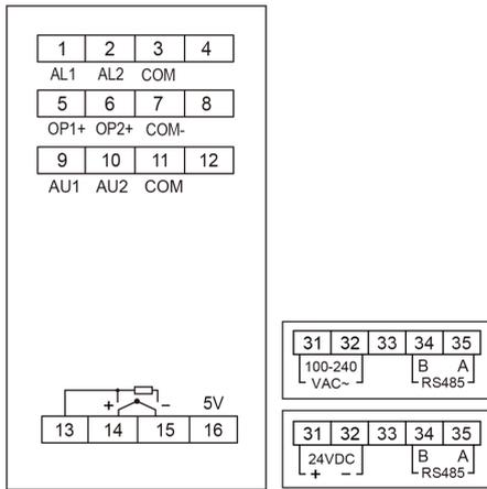
注1: 0-5V/1-5V从15-、16+输入, 100mV以下从14+、15-输入, 4-20mA线性电流输入用250欧姆电阻变为1-5V, 然后从15-、16+输入。
